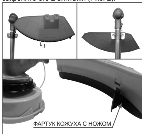
Рис. 2 Установка защитного кожуха
