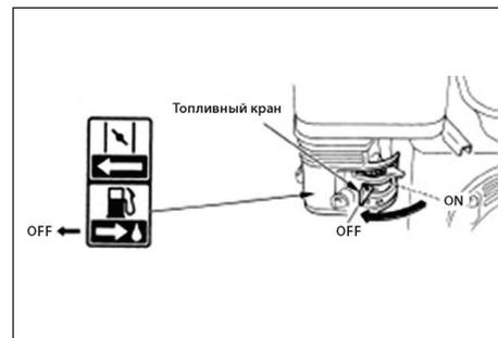
Поверните топливный кран до положения OFF.
