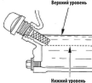
высокодeterгентное, первоклассное моторное масло такого же качества, отвечающее или превосходящее требования класса SG, SF американских производителей автомобилей. Емкости моторных
