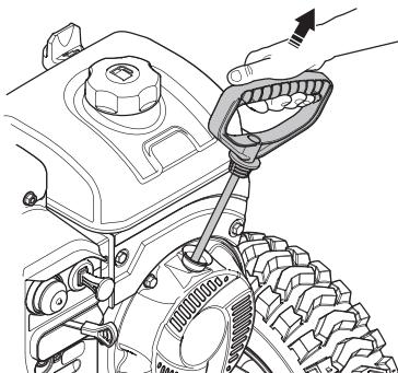
**Примечание!** Не рекомендуется вытягивать шнур стартера максимально (на всю длину), а также резко не отпускайте его при повторной попытке завести двигатель, удерживая рукоятку, плавно верните его в исходное положение.
