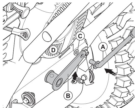
Установите на снегоуборочной машине в отверстие коннектора (B) тягу (A) и закрепите, используйте крепежные элементы - №12: (C) шайба - 1 шт.; (D) шплинт - 1 шт.
