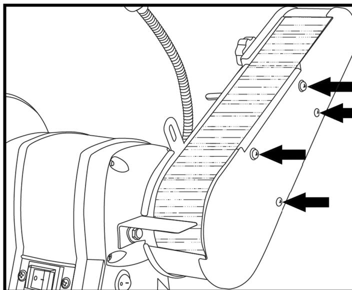
Рис. 16 «Откручивание болтов крышки кожуха шлифовальной ленты»
