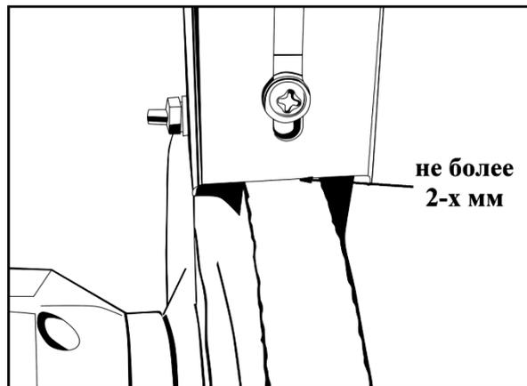
Рис. 4 «Регулировка искрогасителя»
