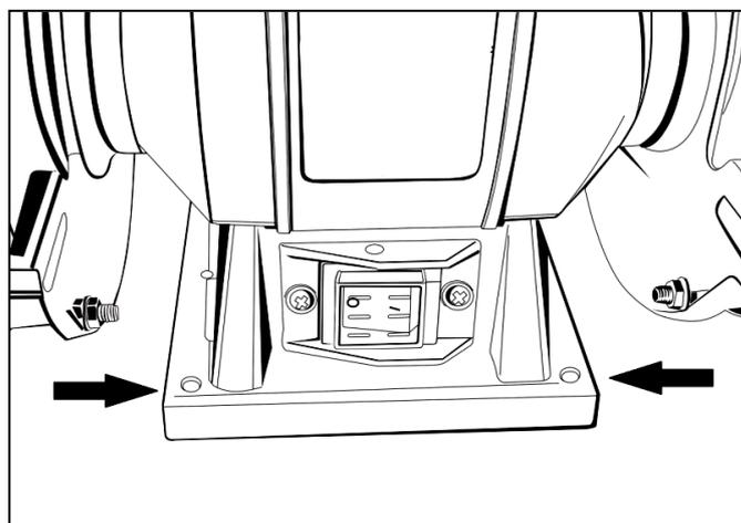
Рис. 8 «Крепление станка на верстаке»
