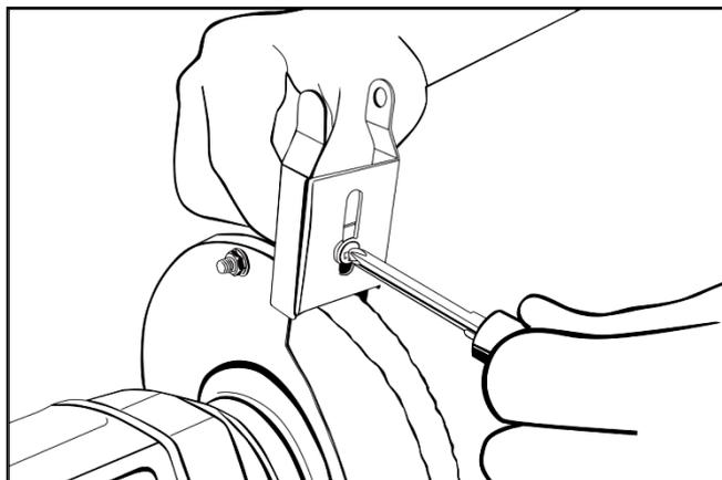
Рис. 3 «Установка искрогасителя»
